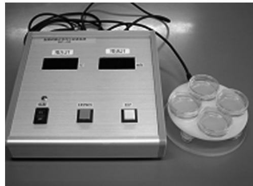
当講座で開発した振動刺激式 骨再生促進装置（DZ-03）
