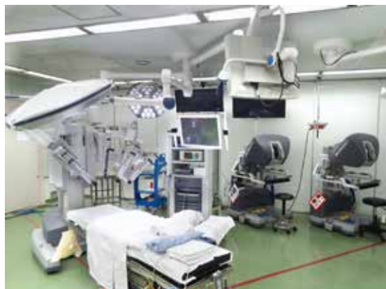
▼遠隔操作型内視鏡下手術システム「ダ・ヴィンチSI」
